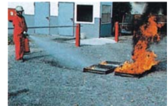
Provbål mot B-brand bestående av 4 st fyrfat med bensin/heptan
