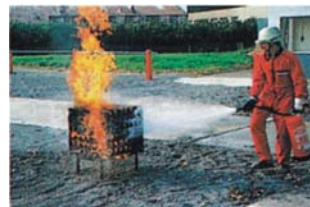
Släckning av provbål mot A-brand bestående av kub med korslagda trästavar
