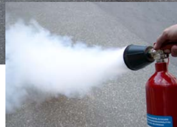
På 2 kg släckaren sitter munstycket monterat direkt i ventilen
