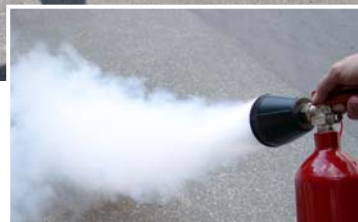
På 2 kg släckaren sitter munstycket monterat direkt i ventilen
